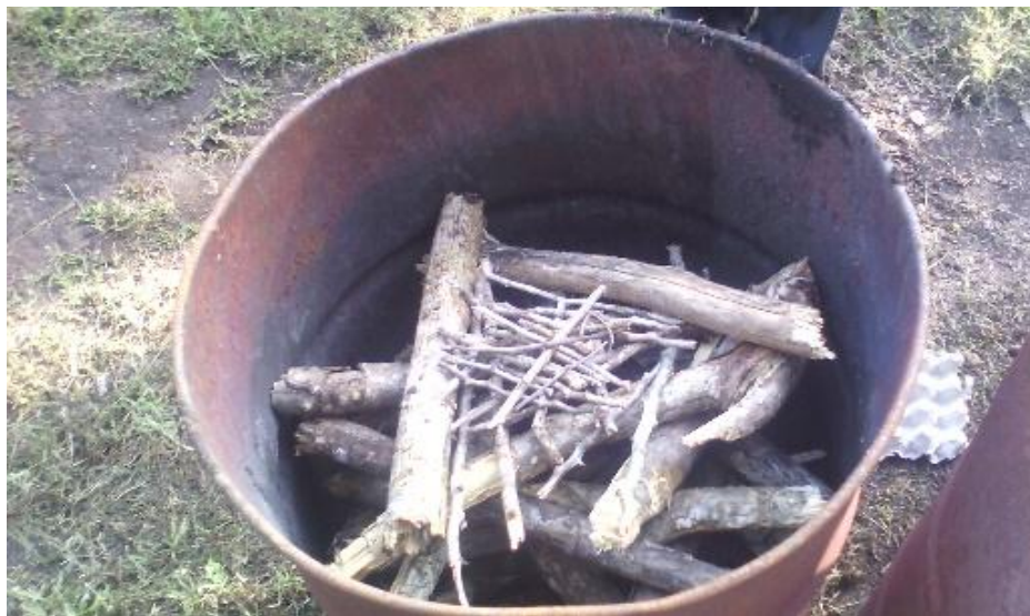
Figura 9 Acomodo de biomasa en el reactor
