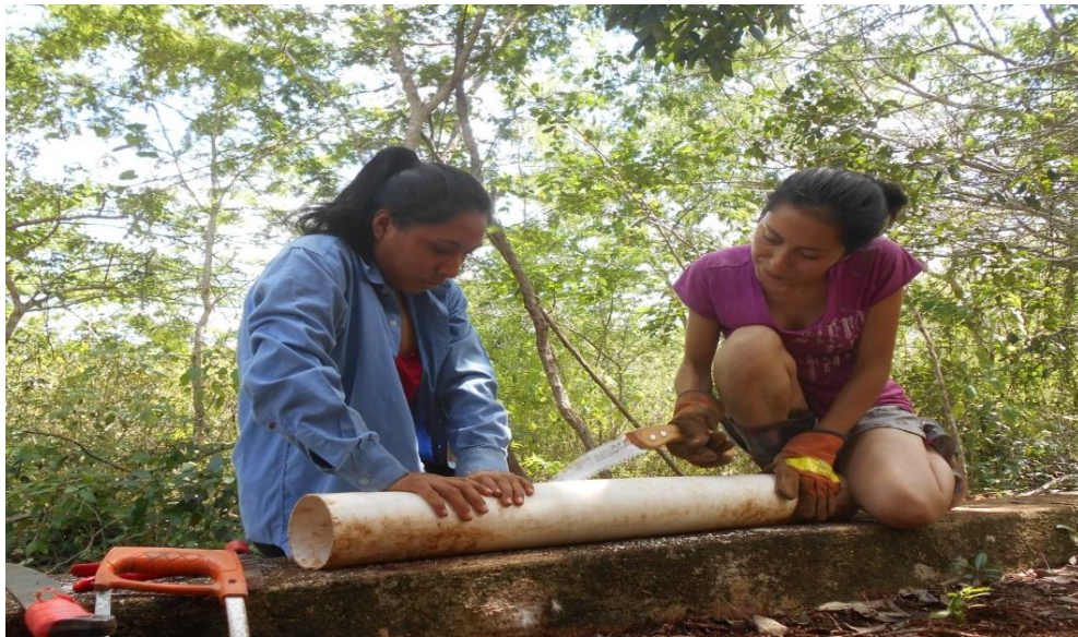
Figura 13 Realización del corte transversal en el tubo de PVC
